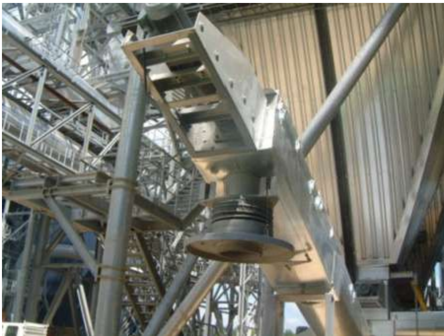
Verladeschnecke mit Verladegarnitur zur staubfreien Verladung der heißen Asche Eingesetzt in einer Spanplattenfabrik
